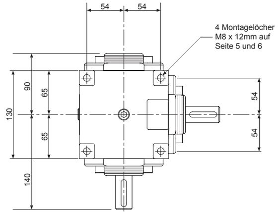
Bohrung mit Gewinde M6 x 16 mm in jedem Ende einer Vollwelle.
