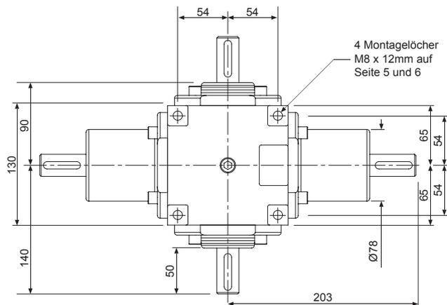
Bohrung mit Gewinde M6 x 16 mm in jedem Ende einer Vollwelle.
