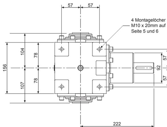
Gewindebohrung am Ende einer jeden Vollwelle - M10 x 25mm tief
