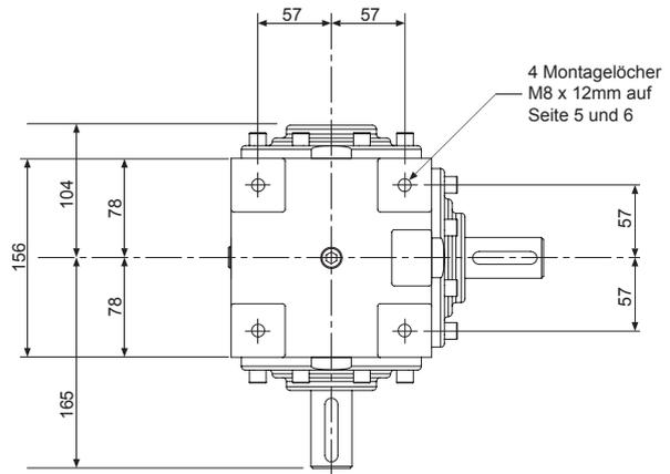
Bohrung mit Gewinde M6 x 16 mm in jedem Ende einer Vollwelle.
