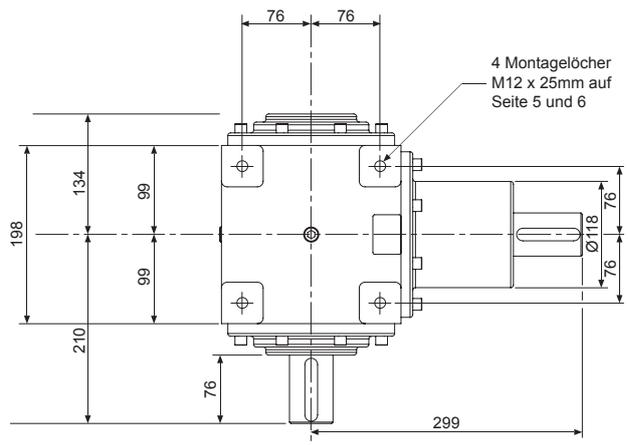
Gewindebohrung am Ende einer jeden Vollwelle - M12 x 30mm tief
