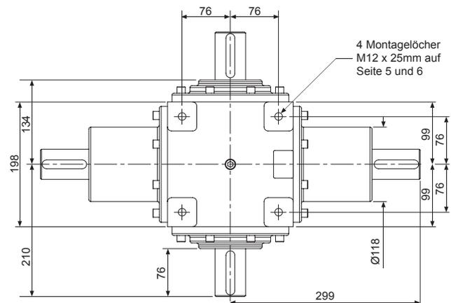
Gewindebohrung am Ende einer jeden Vollwelle - M12 x 30mm tief
