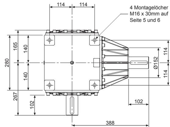
Gewindebohrung am Ende einer jeden Vollwelle - M16 x 38mm tief
