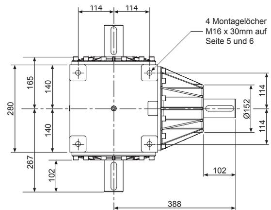
Gewindebohrung am Ende einer jeden Vollwelle - M16 x 38mm tief
