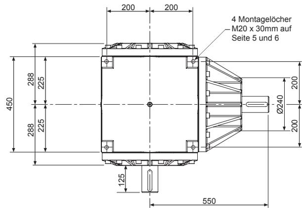
Gewindebohrung am Ende einer jeden Vollwelle - M16 x 38mm tief
