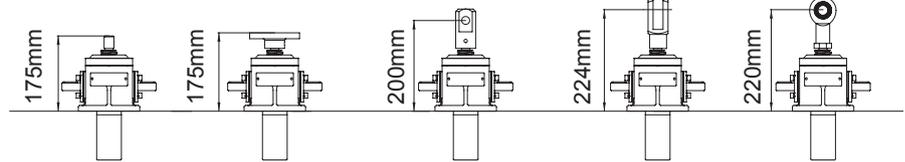
Note: Bemerkung: Bei aufrechter Anordnung mit 10mm Steigung sind 27mm zu dem minimalen Einbaumaß zu addieren.
